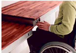
Pöytätason ja kaappien ohjauskytkimet on sijoitettu tason etureunaan.
